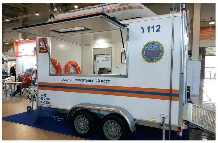
эргономичностью и комфортом. Высокий клиренс и колеса R16 позволяют ему преодолевать любые препятствия вслед за тягачом, а наружная облицовка из рифлёного алюминия надёжно защищает фургон от веток и камней.
