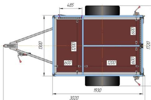
**4. Прицеп-фургон легковой для перевозки 4-х собак (4 секции), модель ИСТОК 3791М2 (арт. 3791М2 СБ-4).**
