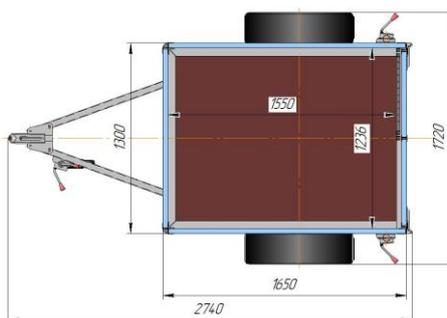
**2. Прицеп-фургон легкой для перевозки 2-х собак (2 секции), модель ИСТОК 3791М1 (арт. 3791М1 СБ-2).**
