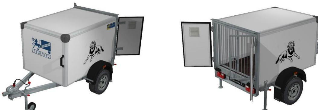
Прицеп-фургон предназначен для перевозки одной-двух собак. Корпус фургона изотермический, выполнен по сэндвич-технологиям. Прицеп выполнен из современных материалов и оснащен системой вентиляции.
