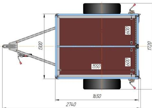
**3. Прицеп-фургон легкой для перевозки 3-х собак (3 секции), модель ИСТОК 3791М1 (арт. 3791М1 СБ-3).**
