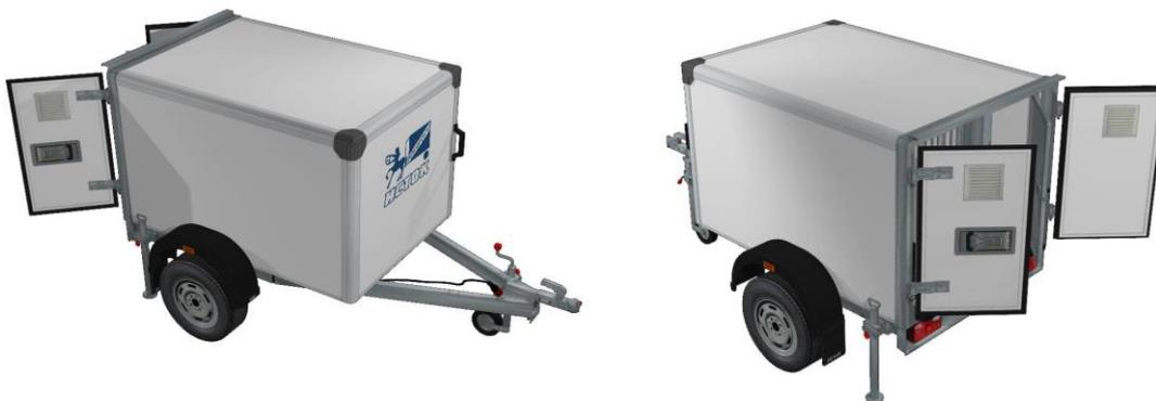
Прицеп-фургон предназначен для перевозки двух собак. Корпус фургона изотермический, выполнен по сэндвич-технологиям. Прицеп выполнен из современных материалов и оснащен системой вентиляции.
