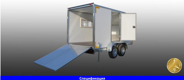
Двухосное «AL-KO» (Германия), без тормоза наката. Подвеска торсионная независимая (резиножгутовая). Материал элементов рамы и дышла - оцинкованная сталь. Прицеп оборудован опорным колесом.
