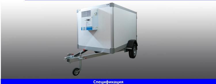
Одноосное «AL-KO» (Германия), без тормоза наката. Подвеска торсионная независимая (резиножгутовая). Материал элементов рамы и дышла - оцинкованная сталь. Прицеп оборудован опорным колесом.
