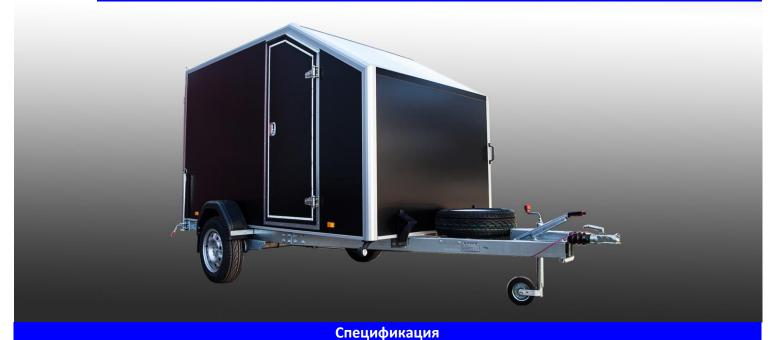
Одноосное «AL-KO» (Германия). Без тормоза наката. Подвеска торсионная независимая (резиножгутовая). Материал элементов рамы и дышла - оцинкованная сталь.
