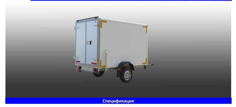
Одноосное «AL-KO» (Германия). Без тормоза наката. Подвеска торсионная независимая (резиножгутовая). Материал элементов рамы и дышла - оцинкованная сталь. Прицеп оборудован опорным колесом. Сцепное устройство «AL-KO» под шар  $\emptyset$  50 мм.
